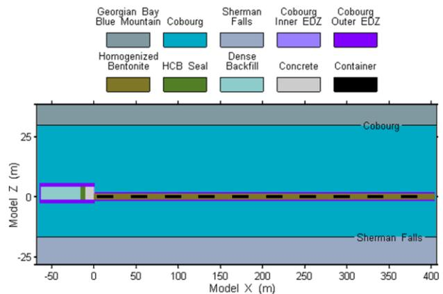
Fig. 1. The Room-Scale Model
